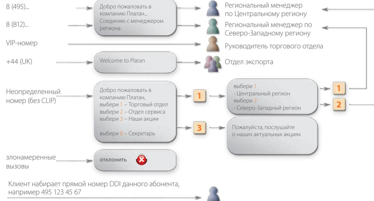
Автоматическое распределение вызовов (ACD) и Инфолинии (IVR) в IP PBX Server Proxima
