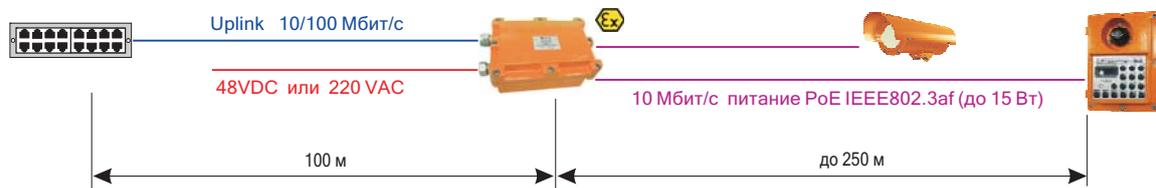
(2) Питание коммутатора через порт Uplink 10/100 Мбит/с от инжектора с выходом Hi-PoE мощностью 60 Вт
