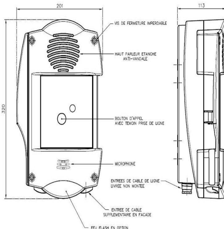
Панель абонента, IP66, 1 кнопка вызова, 5 W, 24/48VDC, корпус из антивандального пластика
